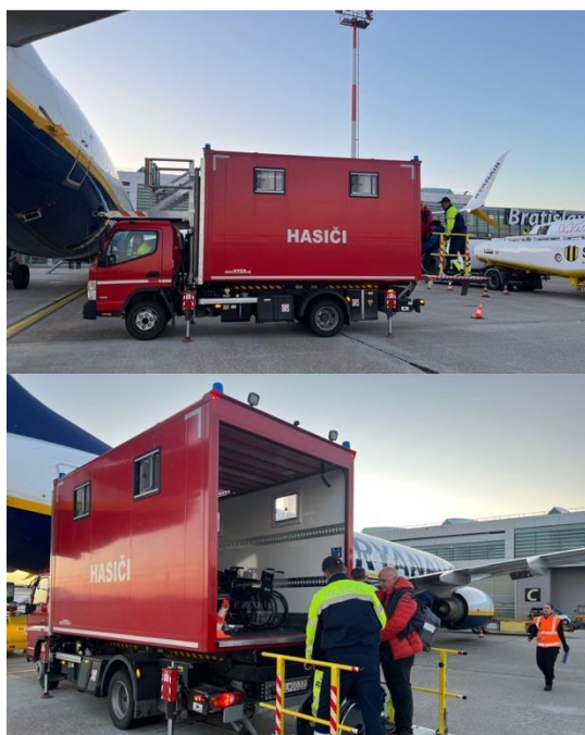
Obr. 4 Proces poskytovania asistencie so zdvíhacou plošinou
